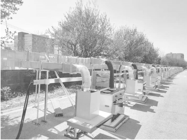
图 5-4 住宅厨房混合排气道系统实验台
