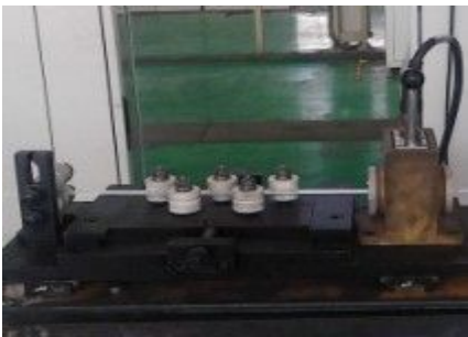
图 5：穿过式单通道探伤应用现场
