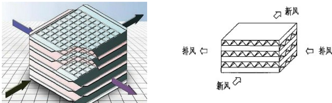
图 1-3 板翅式换热器结构原理图
